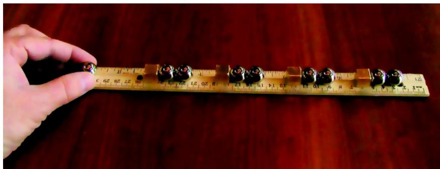
Проще всего убедиться в работоспособности модели, если ее собрать. Для начала найдите деревянную линейку подлиннее. Канавку в ней делать не обязательно, можно наклеить вдоль две полоски картона с разных сторон, оставив свободной среднюю часть, по которой смогут катиться шарики.
